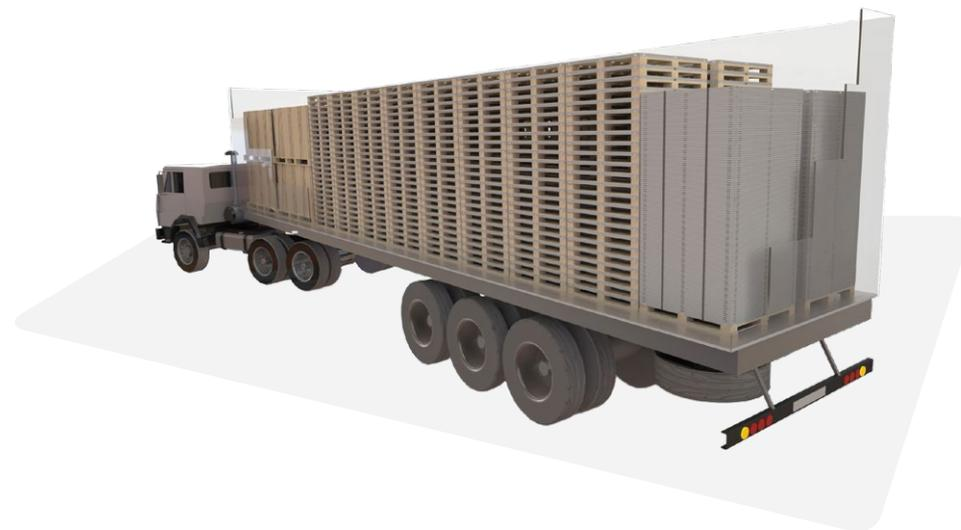
Транспортировка контейнера до места заливки в виде комплекта в сравнении с транспортировкой неразборного «кловертейнера» стандартной «фуры» **эффективнее в 8 раз** т. к. в стандартной «фуре» перевозится 368 комплектов в сложенном виде
